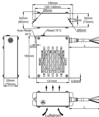
**Modell 9PF2:** Selbstgesteuert, ausgestattet mit einem fest eingestellten Regelthermostat und einem fest eingestellten, manuell rückstellbaren Temperaturbegrenzer.
