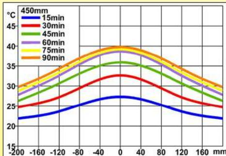
Temperatur von der Mitte zu den Rändern, nach unterschiedlicher Zeit, für 450mm Abstand zwischen Probe und Heizgerät
